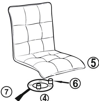
2. В пятилучье ① установите ролики ②, на пятилучье наденьте декоративную пластиковую накладку ⑧, вставьте газлифт ③
