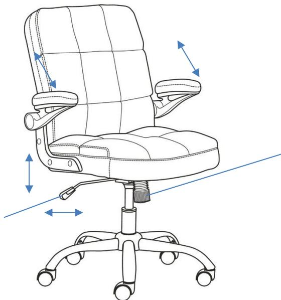
Винт регулировки жесткости качания кресла в зависимости от веса пользователя (находится под сиденьем спереди). Если крутить в сторону «-»/loose – качаться будет легче, если крутить в сторону «+»/tight – качаться будет тяжелее
