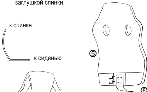
3. Наживите крестовой отверткой Ph3 кронштейн спинки ⑧ к сиденью ⑥ четырьмя винтами М6х25мм через отверстия в металлической площадке. Затяните все винты крепления кронштейна спинки и металлической площадки ④.
